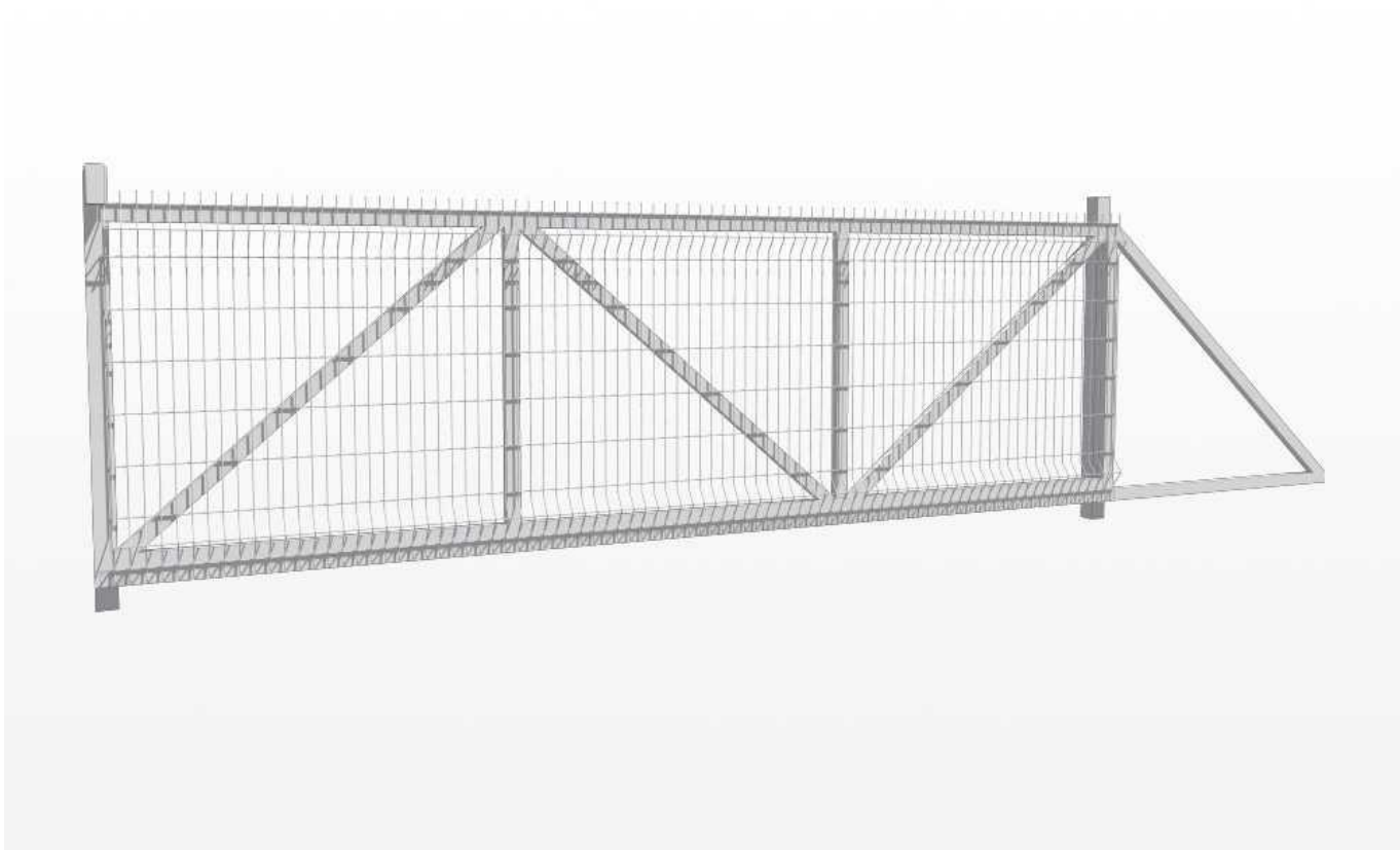
13.2 Paveikslas. Gembinių autmatinių vartų principinė schema
